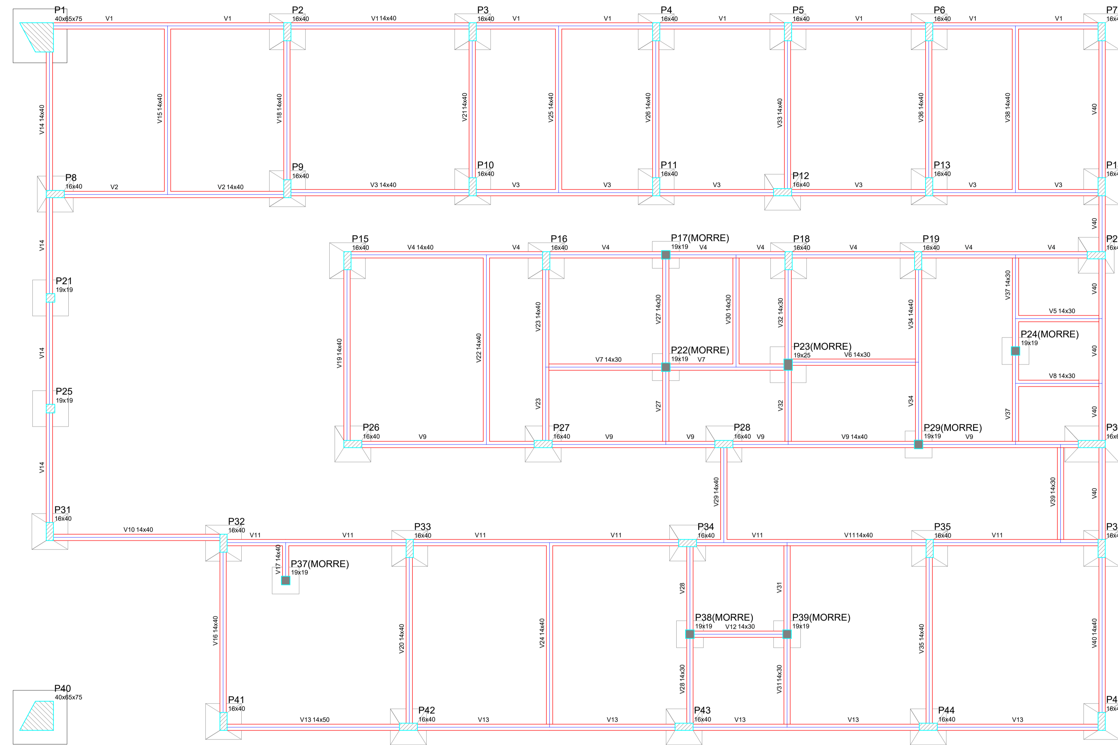
Forma do pavimento Baldrame escala 1:50
