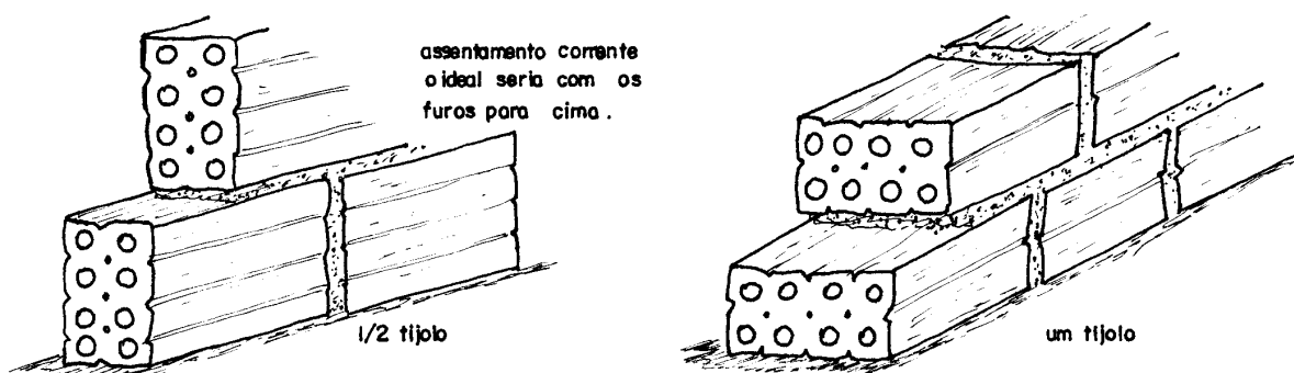
Figura 1 - Execução de alvenaria utilizando tijolos furados.
