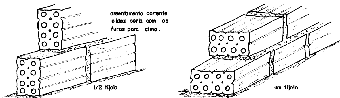
Figura 1 - Execução de alvenaria utilizando tijolos furados.
