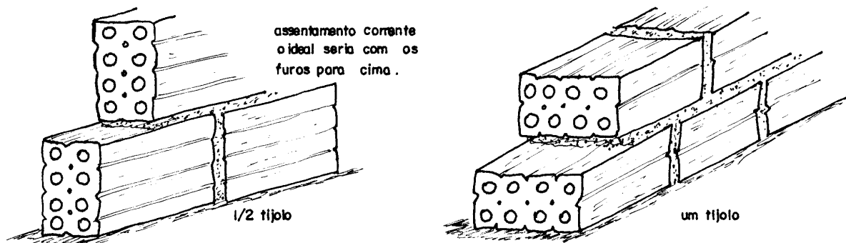
Figura 1 - Execução de alvenaria utilizando tijolos furados.
