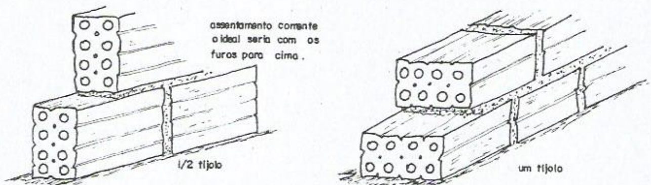
Figura 1 - Execução de alvenaria utilizando tijolos furados.
