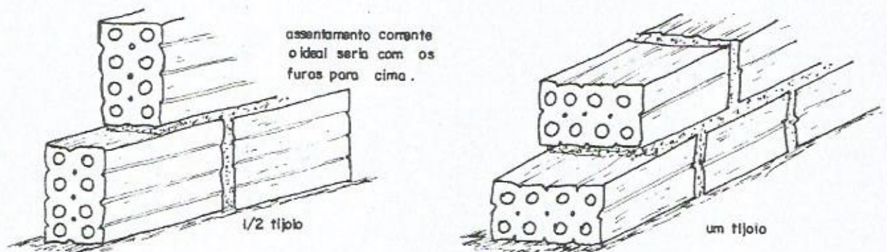
Figura 1 - Execução de alvenaria utilizando tijolos furados.
