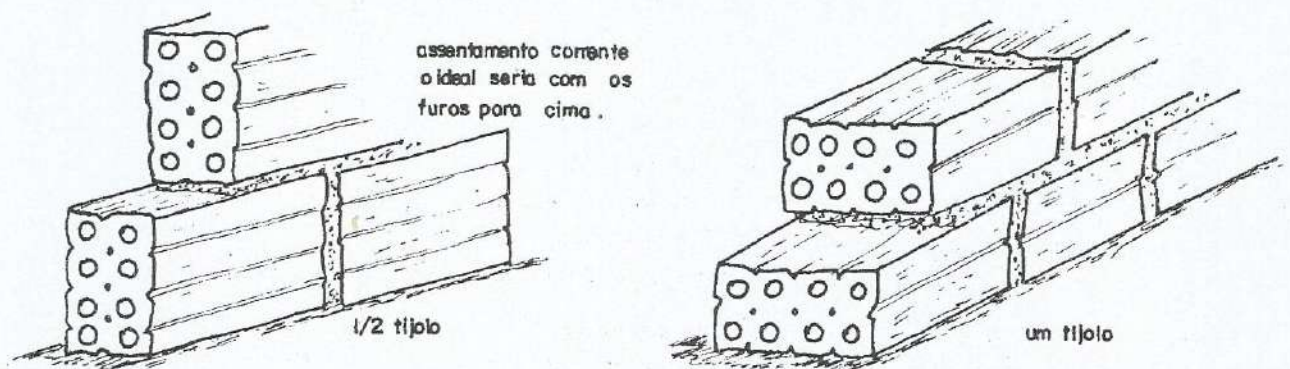
Figura 1 - Execução de alvenaria utilizando tijolos furados.
